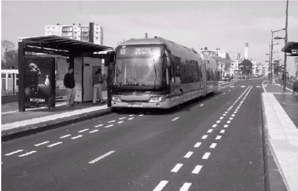
Voie en site propre à double sens de TEOR (On remarquera les pointillés du guidage optique)
