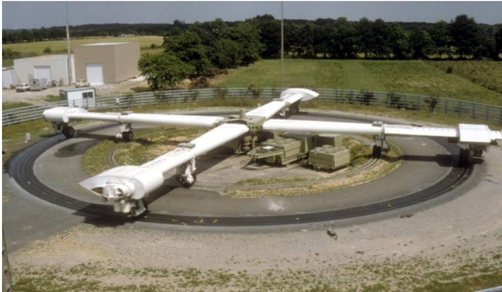
Fig.3.Manège de fatigue de chaussées du LCPC, Nantes
