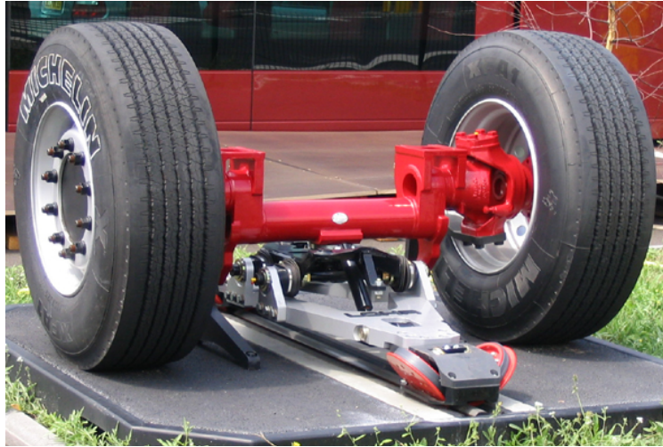
Fig.10. Pneus et système de guidage du tram
