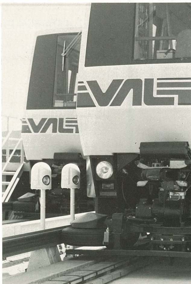
Les deux rames se croisent sur la voie d'essais au droit d'un détecteur négatif.
