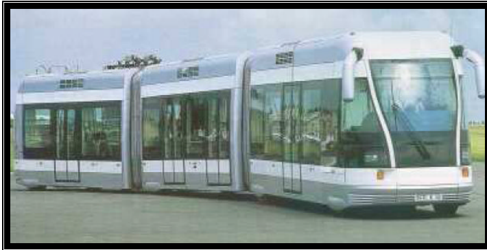
Figure 9 :Le TVR de Bombardier sans le rail de guidage, Tramways & Urban transit, mai 2001
