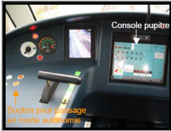
Figure 16 :Pupitre de commande, Tramway de Nice, Alstom
