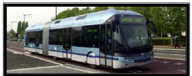
Figure 6 : Matériel Civis d'Irisbus équipé du système de guidage optique, TCAR
