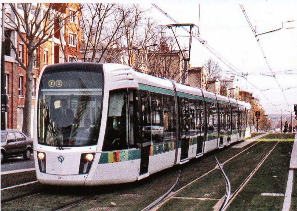
Sur le T3 de Paris, les rames Citadis 402 livrées en 2006 sont à plancher bas intégral et très grande capacité, grâce à un gabarit "large" de 2,65 m et une longueur de 41 m. (Cliché Y. Allain)
