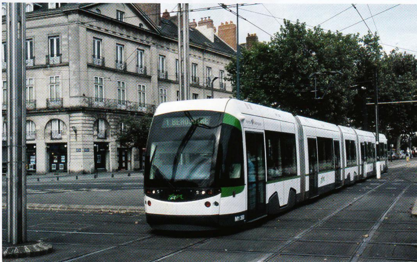
À partir de 2000, afin de développer son parc pour l'ouverture de nouvelles lignes, Nantes a reçu du constructeur AD Tranz (intégré ultérieurement au groupe Bombardier) des nouvelles rames Incentro à plancher surbaissé, de conception similaire aux Citadis 302 (cinq caisses reposant sur trois bogies dont deux moteurs, gabarit standard de 2,40 m). (Cliché Yves Allain)
