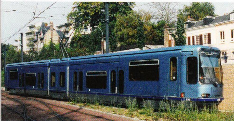
Circulant sur le réseau "Métrobus" de Rouen, cette rame de TFS-2 nous montre bien la partie centrale surbaissée, avec le décalage correspondant des baies vitrées.
