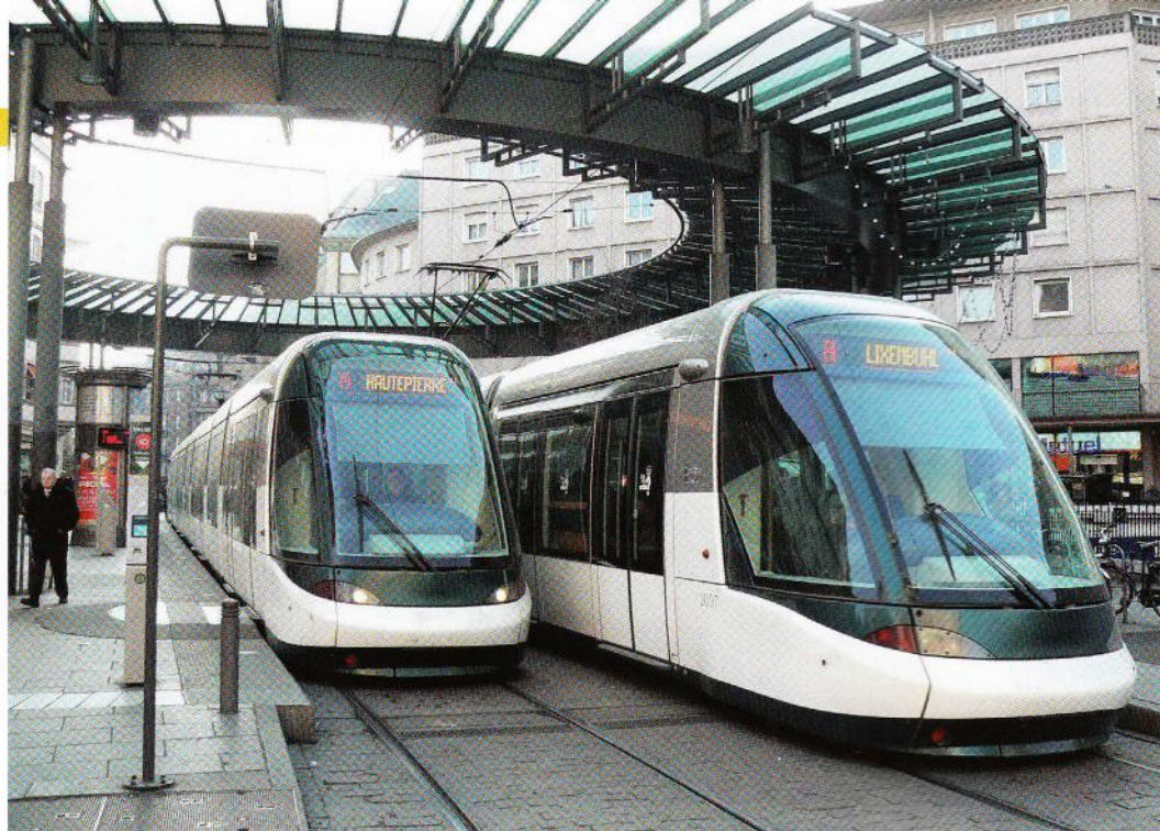
Non, il ne s'agit pas d'Eurotram se croisant place de l'Homme de Fer, mais de Citadis 403 spécialement dessinées par MBD pour le réseau strasbourgeois. Sous le poste de conduite se trouve un petit bogie porteur qui élimine le porte-à-faux d'extrémité. (Cliché MBD)
