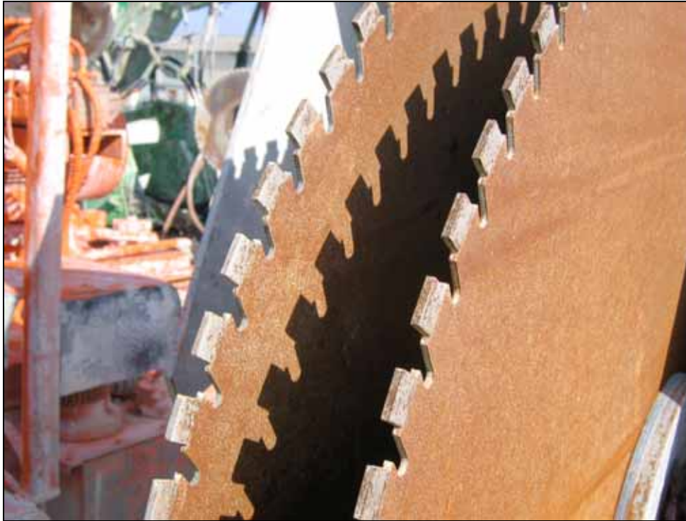
Disques avec dents au carbure de tungstène pour attaquer les parois rocheuses
