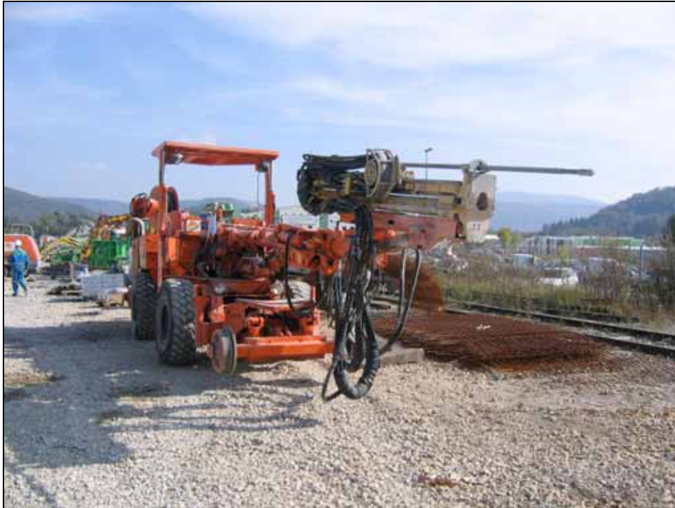
Perforatrice (rail- route) pour fixer les tiges boulonnées de soutien des parois
