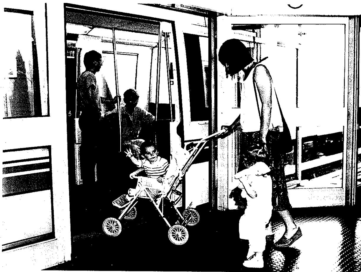
Figure 6: Le VAL est accessible aux personnes à mobilité réduite. A l'arrivée de la rame en station, les portes palières et les portes du véhicules s'ouvrent simultanément. Le plancher de la voiture est au niveau du quai.
