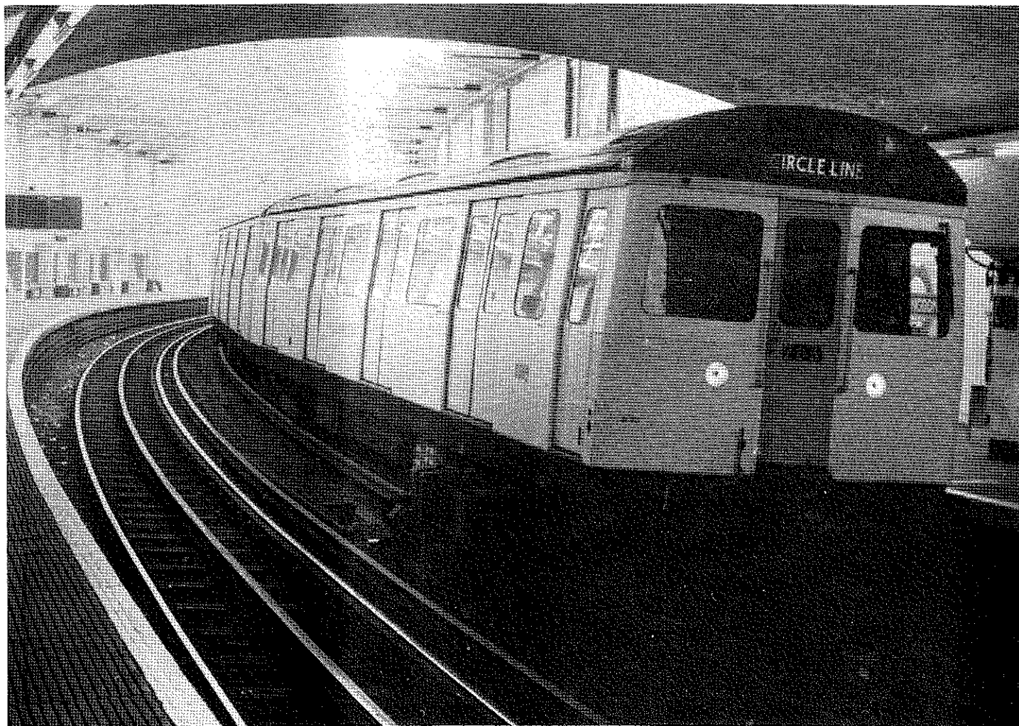
▲ Motrice d'extrémité d'une rame « Underground » assurant la « Circle Line ». Noter à gauche le rail central de retour du courant (Cliché M. Bézy).
