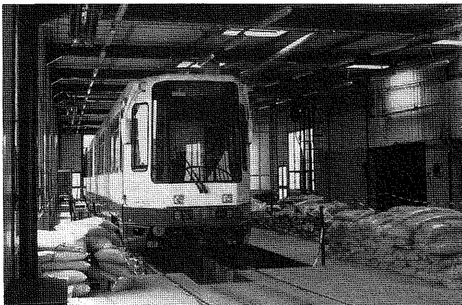
▲ Rame M 03 dans la «station-service» des nouveaux ateliers de Dalby. Noter de part et d'autre de la fosse les sacs de lest destinés aux essais en charge. (Cliché Brossier).
