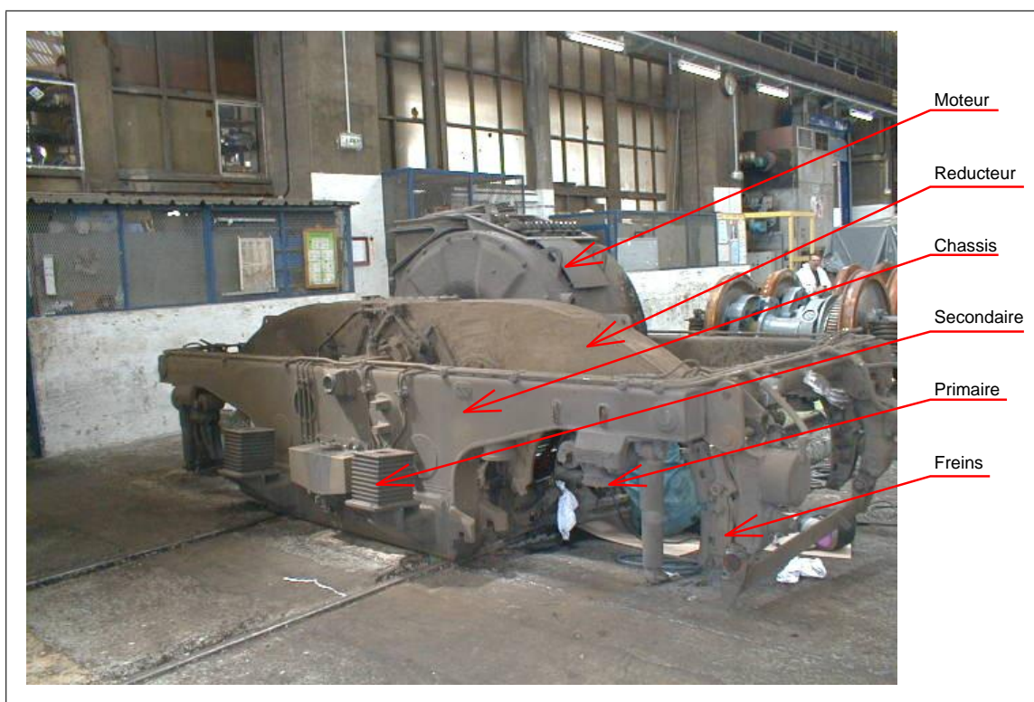
FIG. 1.3 – Bogie d'une locomotive BB 26000
