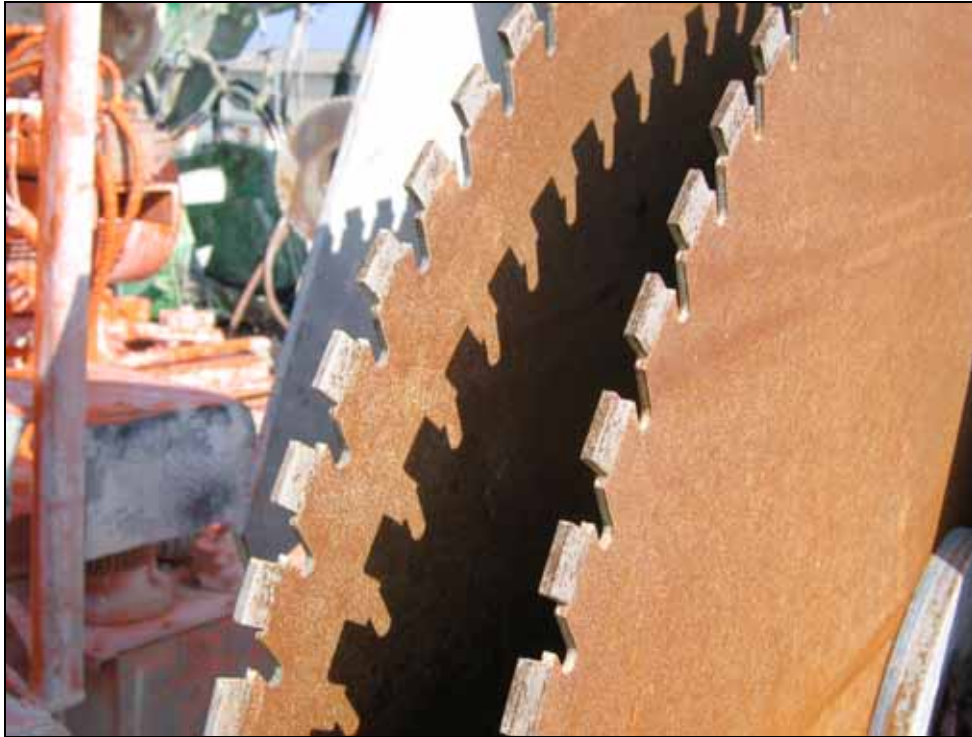
Disques avec dents au carbure de tungstène pour attaquer les parois rocheuses
