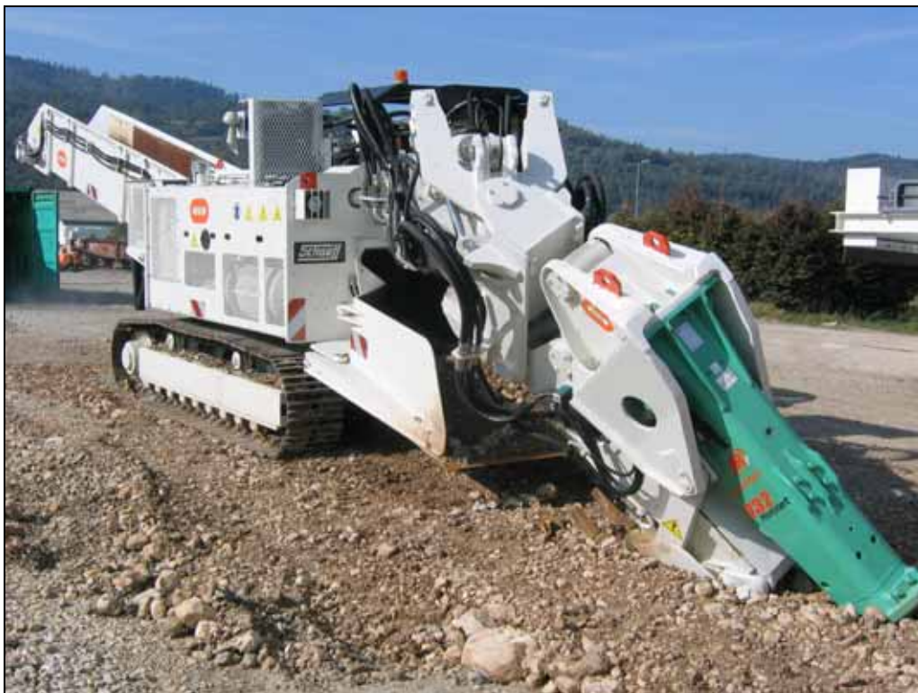
Engin sur chenille d'attaque avec marteau et godet des parois avec possibilité d'évacuation des déblais vers l'arrière par tapis roulant
