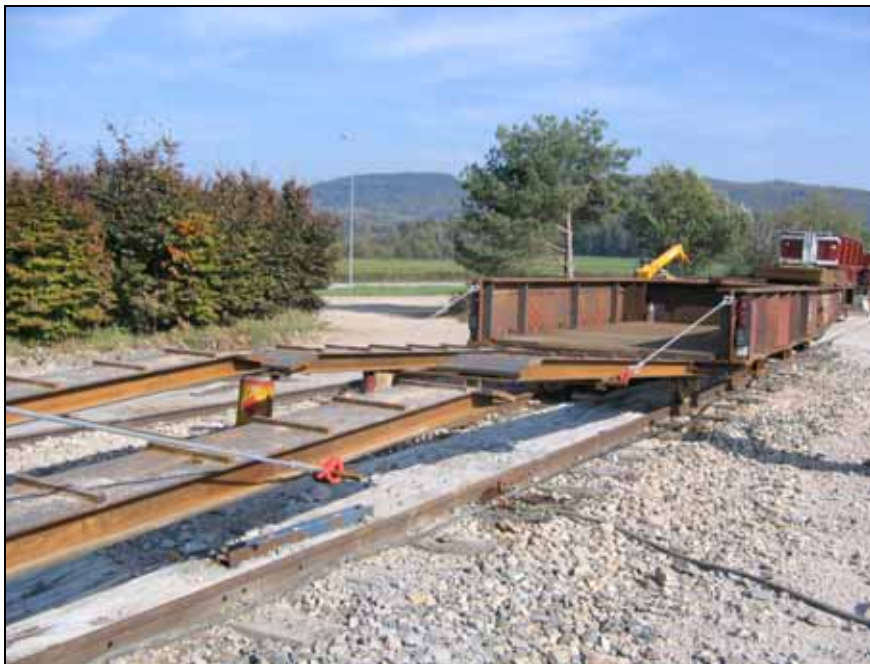
Remorques sur rail pour amener les engins de TP à pied d'œuvre dans le tunnel
