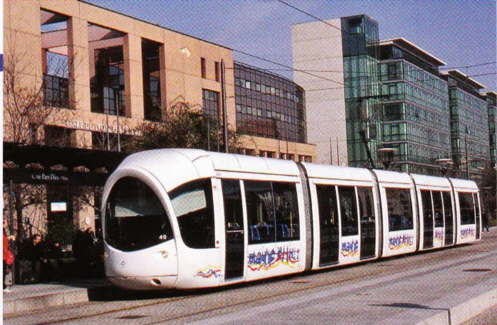
À Lyon, les rames Citadis 302 livrées à partir de 2000 sont à plancher bas intégral et au gabarit standard de 2,40 m. (Cliché Yves Allain)
