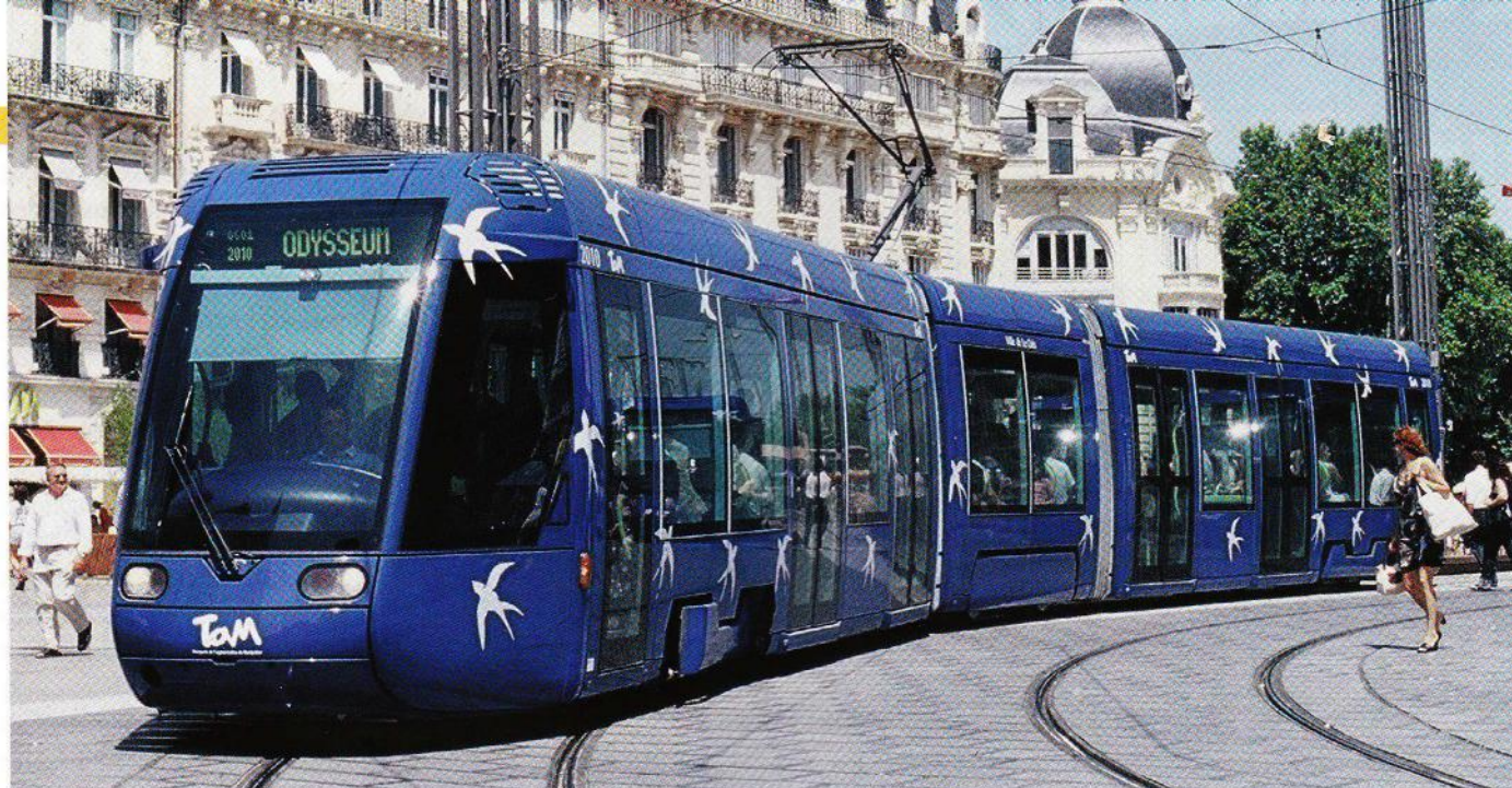
À Montpellier, une rame "courte" type Citadis 301 arrive sur la place de la Comédie. Au gabarit de large de 2,65 m, elle comporte un petit élément porteur central encadré par deux caisses reposant chacune sur un bogie moteur d'extrémité. (Cliché P.L.)
