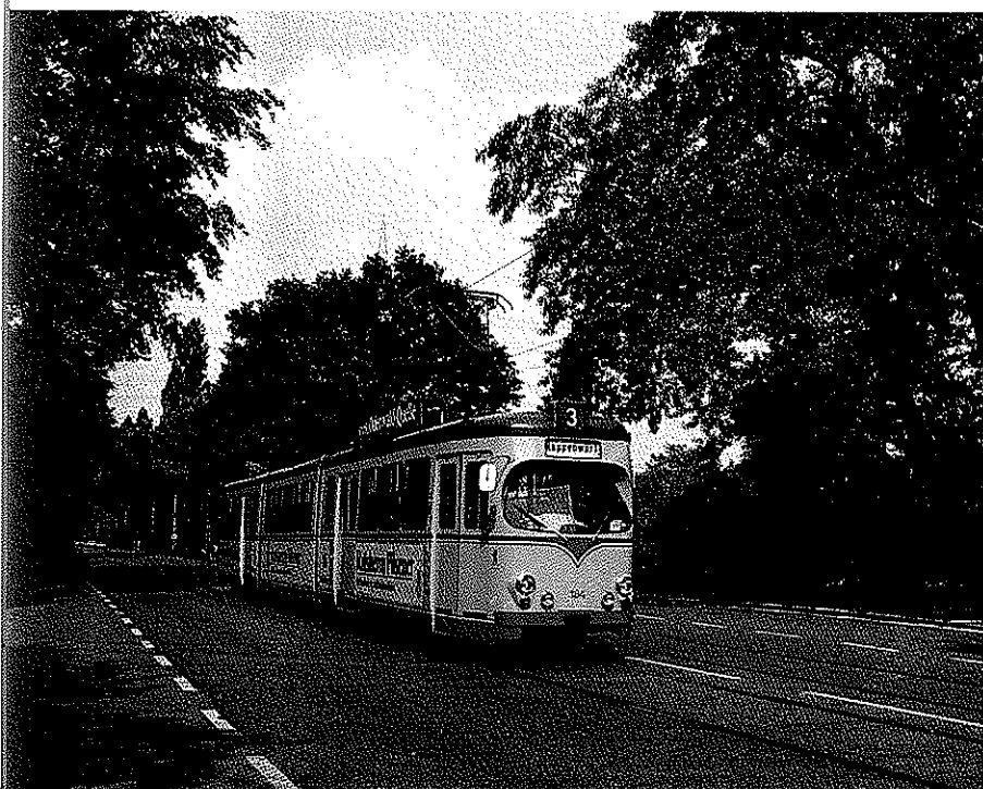
Fig. 5. - Dès la fin des années 1960, le réseau urbain de Karlsruhe s'équipe d'automotrices articulées doubles puis triples. Une rame triple de 1969.
