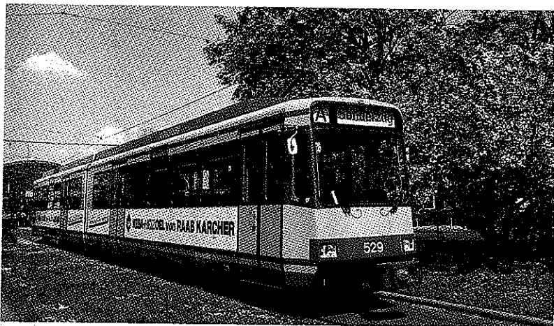
Fig. 10. - Matériel de nouvelle génération, type Stadtbahn, ici en version d'origine à 2 caisses (GT6-80C).
