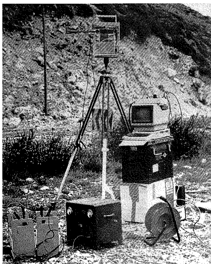
Photographie 2: Dispositif récepteur 10 GHz à diversité d'espace et système d'acquisition de données en fonctionnement sur site d'essai
