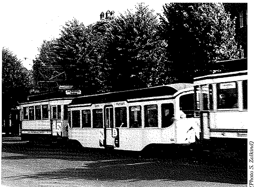
Fig. 2. - Rame du tramway Bonn - Bad Godesberg - Melhem vers 1950, comportant une remorque à bogies à plate-forme centrale surbaissée.
