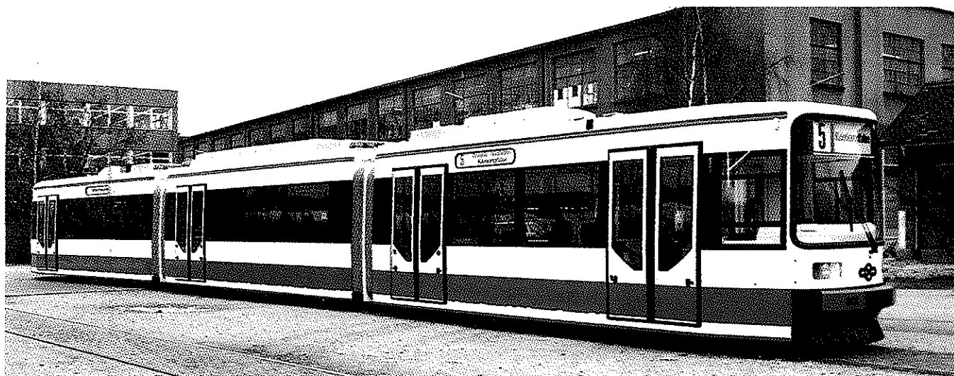
Fig. 19. - La première rame allemande à plancher bas intégral est apparue à Brême en 1990 et a préfiguré une importante filiation.
