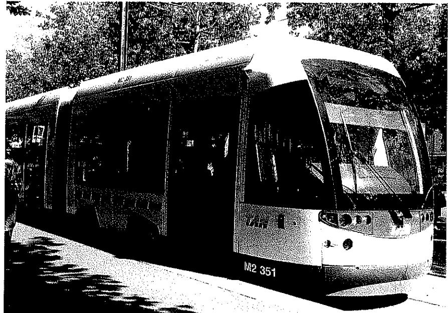
Le client SEMITAN a commandé 28 tramways à plancher bas intégral pour la ville de Nantes. Ces tramways sont conçus pour un service bidirectionnel et ont une capacité de 239 passagers. Leur flexibilité opérationnelle et leur maintenance aisée sont des qualités
