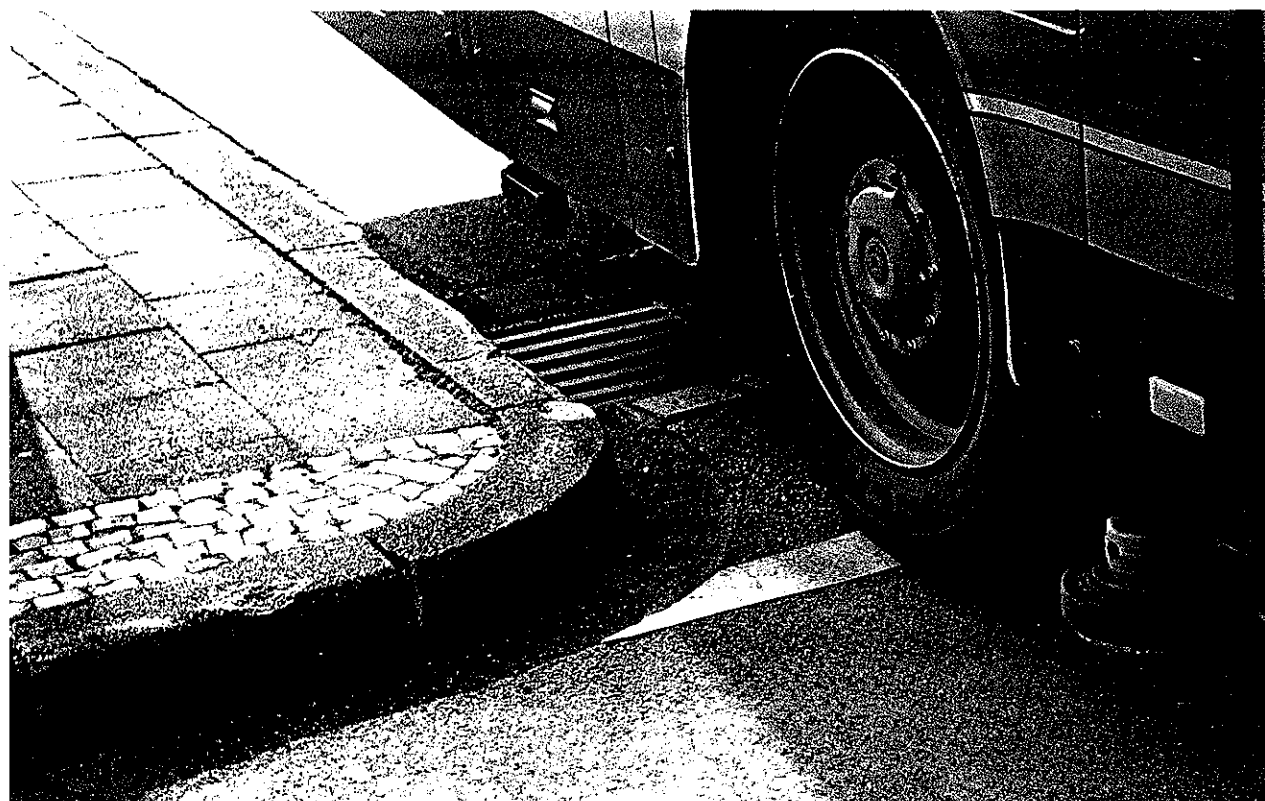
Spurbus Hinterrad mit Drängelrolle und Freimeldemagnet (Im Vordergrund ein durch Berührungen mit Spurführungsrollen beschädigter Bordstein) Guided bus rear wheel with pusher roller and magnet for reporting free sections (In the foreground a kerb damaged by contact with guide wheels)
