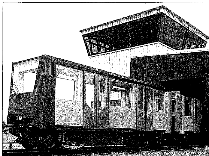
Abb. 4: TAU-Fahrzeug (Transport-Automatisé-Urbain), BN/ACEC, der Teststrecke in Jumet. Länge: 2 \times 8750 mm, Breite 2060 mm, Leergewicht 16 t. Vmax: 72 km/h
