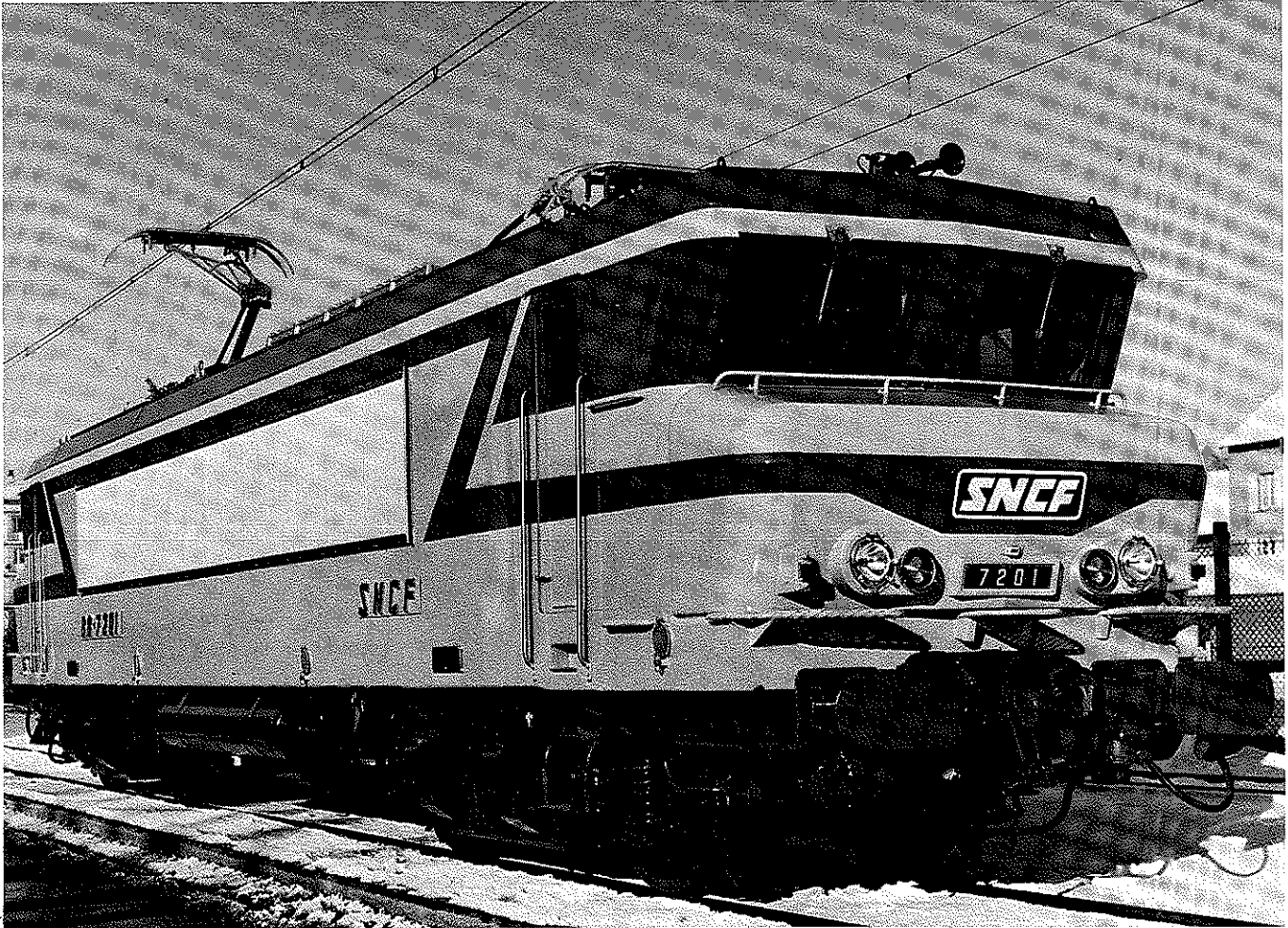
Fig. 19 Locomotive électrique à courant continu 1500 V - Série EU 4500 C1 - type BB 7200 à bogie monomoteur avec freinage rhéostatique. Puissance 4400 kW - Vitesse maximale possible 180 km/h. Vitesse maximale de service 160 km/h.
