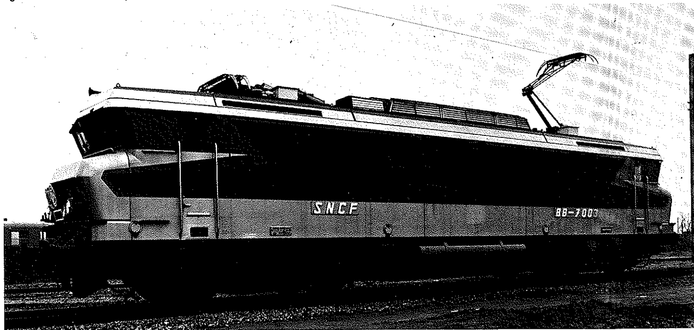
Fig. 1 Locomotive électrique à courant continu 1500 V. BB 7003 SNCF - équipée de bloc hacheur.
