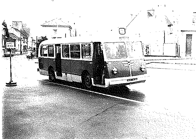
Fig. 1. Plusieurs réseaux, dont celui de Rennes, ci-dessous, ont utilisé cet autobus MGT équipé d'un moteur Panhard (photo C. Brizard).
