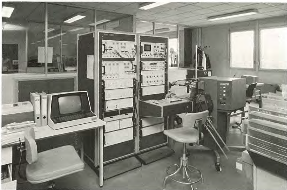
Baie de test des circuits intégrés
