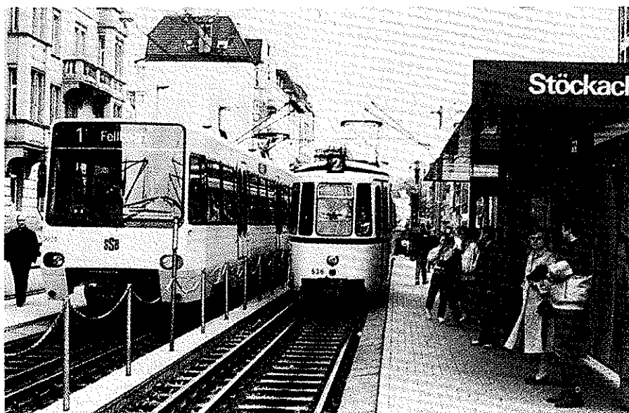
A gauche : le nouveau matériel « Stadtbahn », à voie normale ; à droite : le tramway à voie métrique (noter les trois files de rails).
