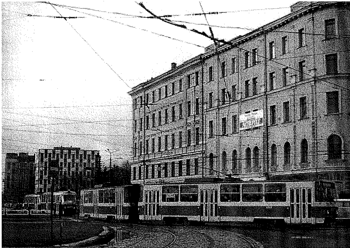
In Riga werden noch Stangenstromabnehmer mit Kontaktschuh verwendet, hier bei einer Doppeltraktion aus zwei T6B5SU mit Tw 3217 im November 1991. (Foto: Martin Pabst)
