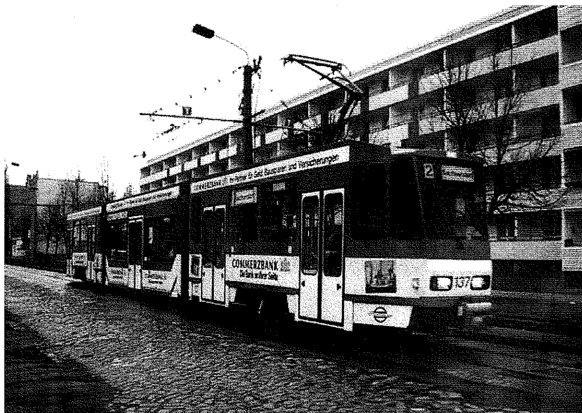
Der Cottbuser KTNF6-Tw 137 (Baujahr 1987, 1997 ex. KT4D 37) ist am 15. Februar 1998 gerade aus dem Betriebshof Berliner Straße zum Einsatz auf der Linie 2 nach Sachsendorf ausgerückt. (Foto: Nase)
