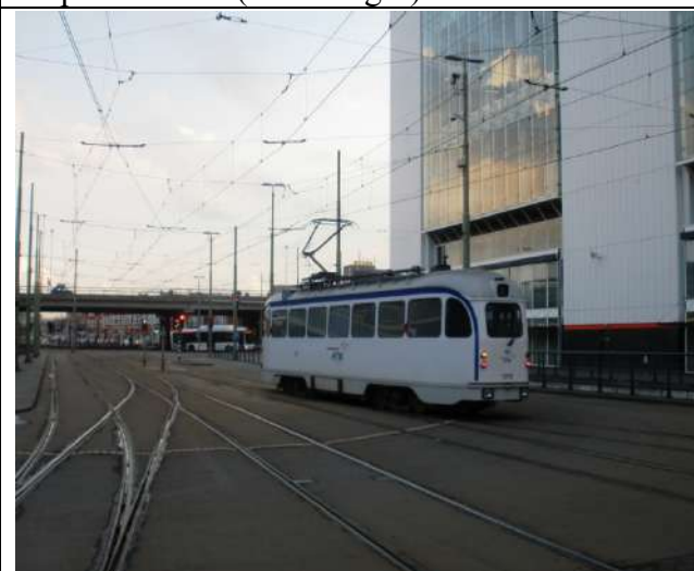
Une ancienne rame PCC « meuleuse » des rails
