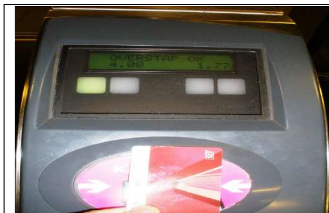
L'équipement de paiement par carte (rechargeable). Cette machine indique le tarif du déplacement effectué (à gauche) et le solde en euros restant sur la carte
