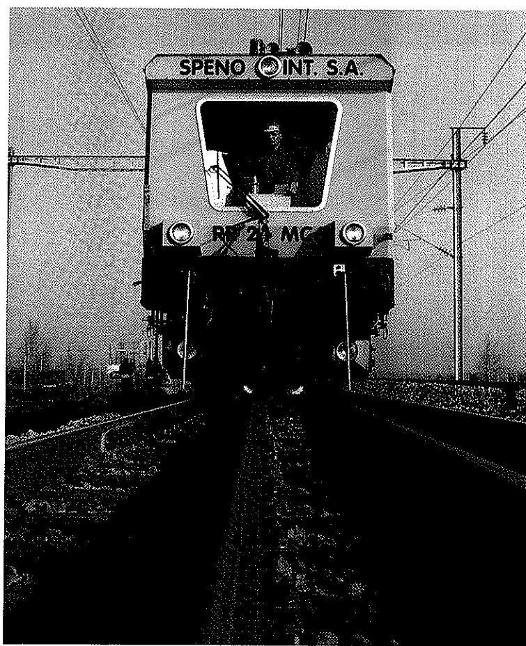
Fig. 36. - Train de 24 meules avec aspiration des poussières et catalyseur chimique.
